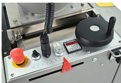
SLIM Globe предназначены для ежедневного использования. Машина оснащена электронным регулятором скорости и счетчиком порций.
