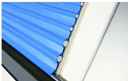
Пружинную пищевую цепь для закатки можно легко снять и очистить.
