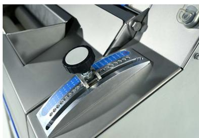
Удобные рычаги для точного позиционирования и регулировки роликов подающего конвейера и роликов конвейерной ленты.
