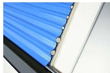
Пружинную пищевую цепь для закатки можно легко снять и очистить.
