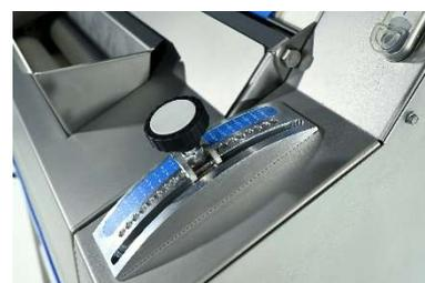
Удобные рычаги для точного позиционирования и регулировки роликов подающего конвейера и роликов конвейерной ленты.
