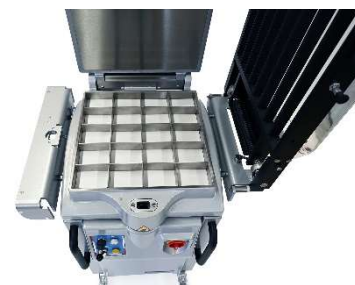
Высококласный делительный нож из нержавеющей стали для деления теста на куски от 120 до 3340 г.
