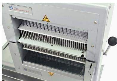
Прочная стальная конструкция с легкими деталями обеспечивает бесшумную работу.
